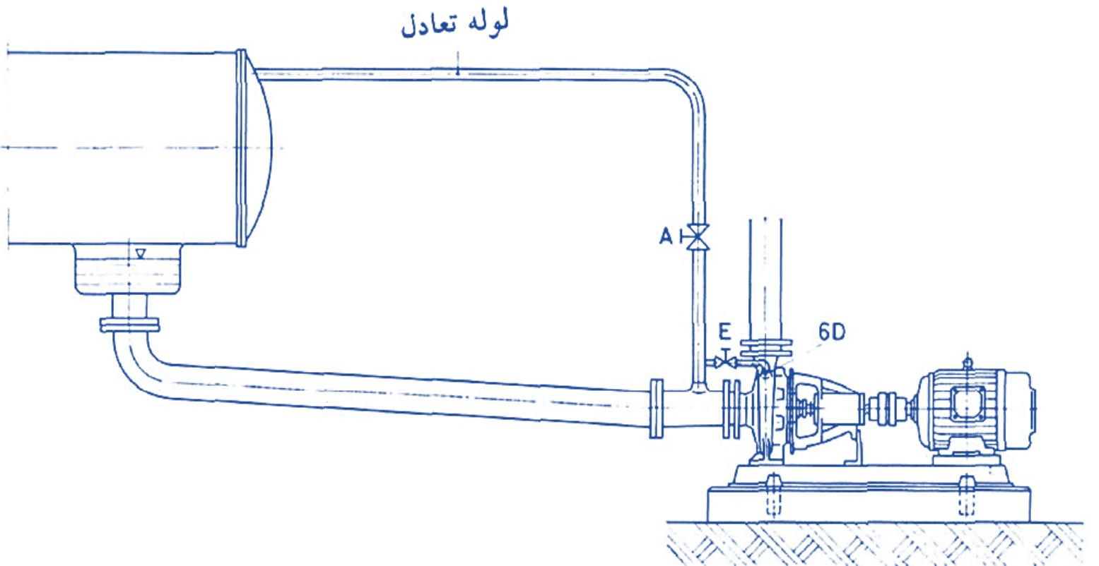
در مسیر مکش با ارتفاع مثبت نیز وجود شیر قطع و وصل لازم است تا بتوان هنگام بازررسی و تعمیرات، پمپ را از منبع مربوطه جدا کرد. این شیر هنگام بهره بردارب از پمپ باید کاملاً باز باشد. لوله مکش باید با شیب یکنواخت نزولی به طرف پمپ نصب شود تا از حبس هوا جلوگیری شود.
