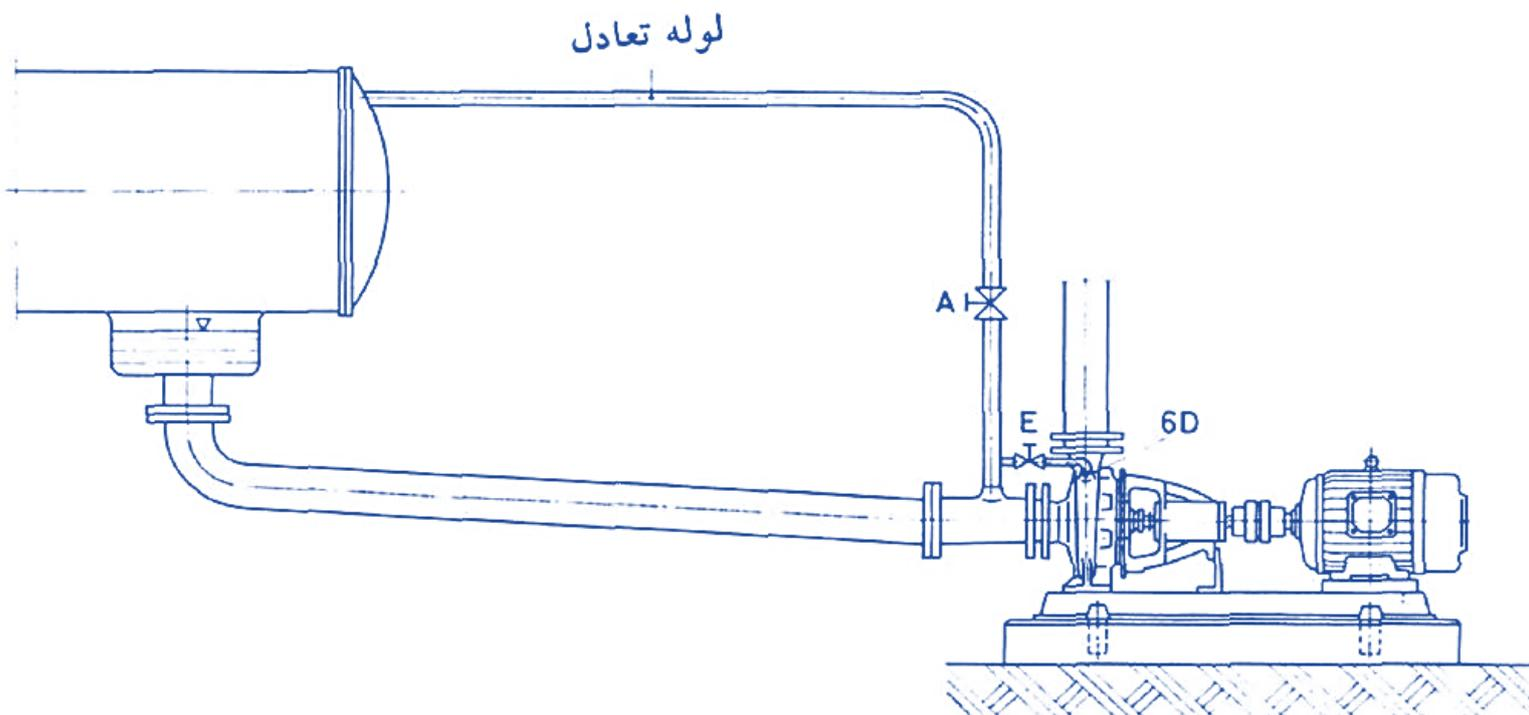
نقطه بالای محفظه پمپ (سوراخ هواگیری 6D) باید توسط یک لوله کوتاه به مسیر خلاء وصل شود تا پمپ قبل از راهاندازی هواگیری شود. روی این لوله شیر ضد خلاء E نصب می شود که باید پس از هواگیری و قبل از راه اندازی بسته شود. شیر قطع و وصل اصلی مسیر تعادل A باید در زمان بهره برداری از پمپ کاملاً باز باشد و فقط هنگام خاموش بودن پمپ بسته شود.
