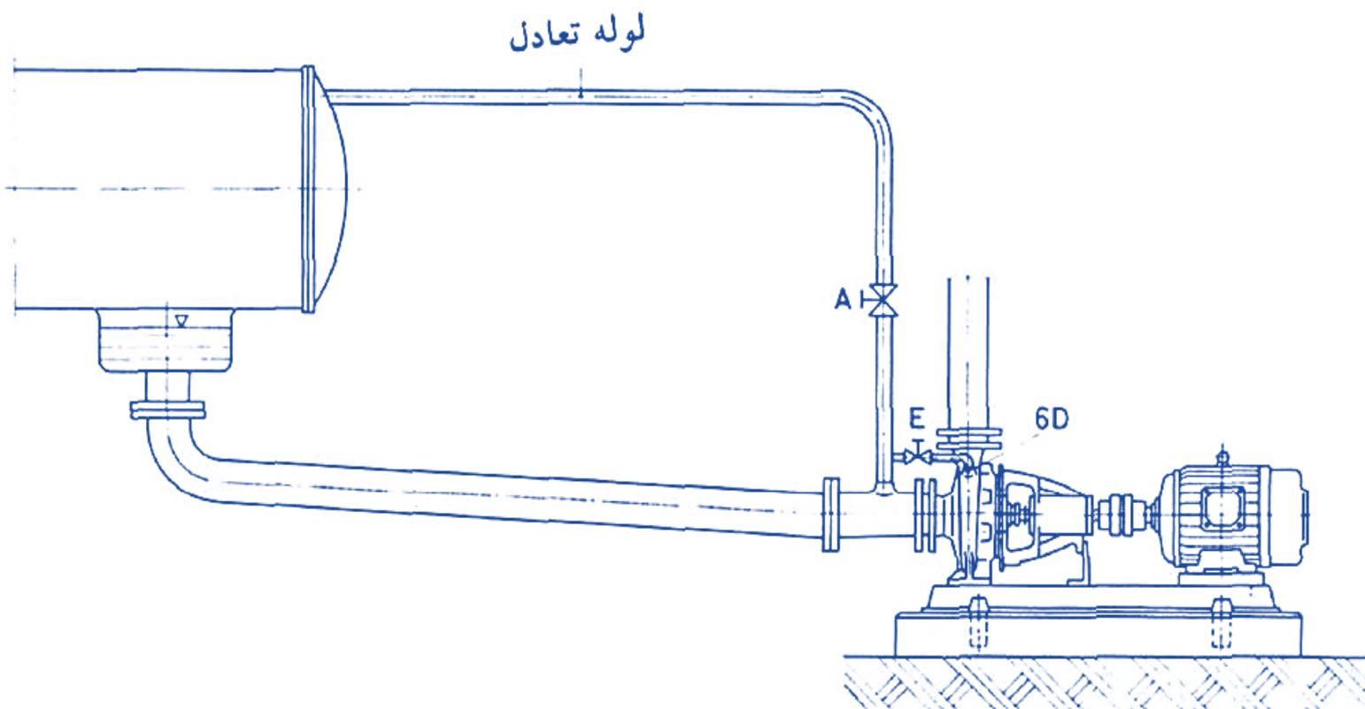
در مسیر مکش با ارتفاع مثبت نیز وجود شیر قطع و وصل لازم است تا بتوان هنگام بازرسی و تعمیرات، پمپ را از منبع مربوطه جدا کرد. این شیر هنگام بهره بردار از پمپ باید کاملاً باز باشد. لوله مکش باید با شیب یکنواخت نزولی به طرف پمپ نصب شود تا از حبس هوا جلوگیری شود.
